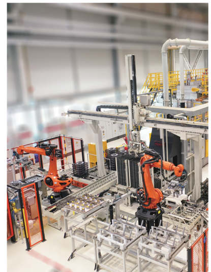
▲ 机器人上卸料，可实现生产线无人化作业
